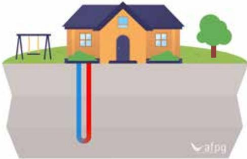
Figure 2 : Schéma de principe du captage par système fermé
