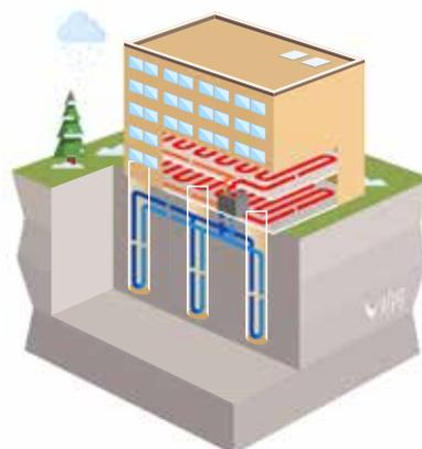
Figure 4 : Schéma de principe des fondations thermoactives
