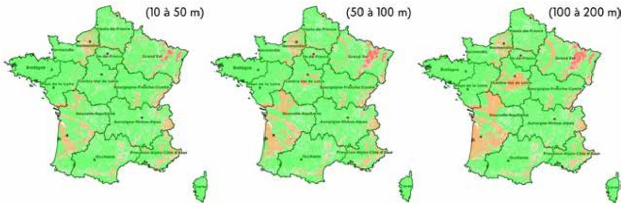
Figure 42 : Cartes des zones réglementaires GMI pour les opérations sur sondes
