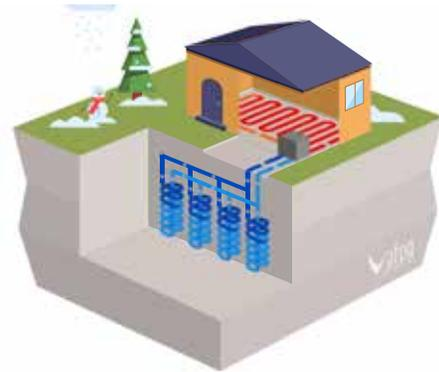
Figure 7 : Schéma de principe des corbeilles géothermiques
