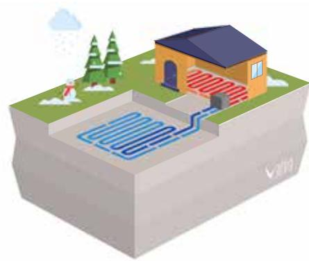
Figure 5 : Schéma de principe du captage horizontal
