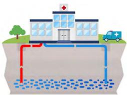
Récupération de l'énergie contenue dans les nappes d'eau souterraine via un échangeur et une PAC puis réinjection de l'eau prélevée dans son milieu naturel pour pérenniser la ressource.
