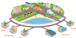
Mutualisation d'un ou plusieurs captages géothermiques pour desservir plusieurs bâtiments via un réseau de distribution (boucle). Chaque bâtiment est équipé d'une PAC pour chauffer/rafraîchir son réseau interne.
