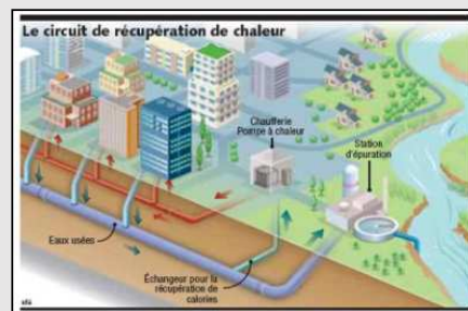
PAC sur eaux usées
